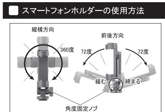
ホルダーは縦横方向に45度きざみで360度回転します。前後方向の調整は角度固定ノブを一度緩めてください。それぞれ24度きざみで72度まで倒すことが可能ですので、希望の位置まで倒したら角度固定ノブをしっかりと締めてください。
