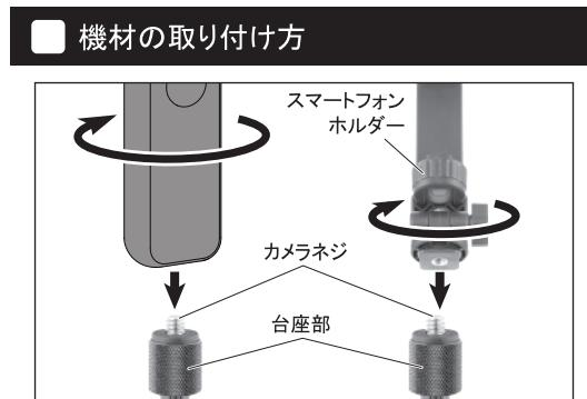
スタンドに撮影機材や付属のスマートフォンホルダー、アクションカメラアダプターを取り付ける際は、台座部を手で押さえながら上図矢印方向に回して取り付けてください。
