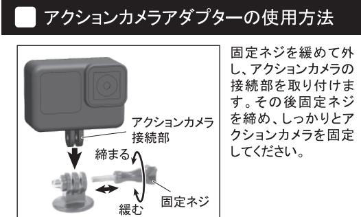
固定ネジを緩めて外し、アクションカメラの接続部を取り付けます。その後固定ネジを締め、しっかりとアクションカメラを固定してください。
