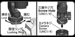
アクセサリーシューに取り付ける際は、一度固定 リングを緩めてください。取り付け時はしっかり 固定し、ずれない事を確認してください。
