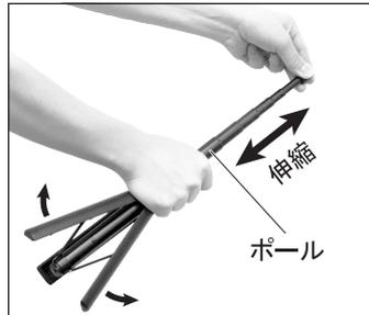
ローレット部を一方の手でつまみ、グリップとローレット部をそれぞれ反対方向へゆっくりスライドさせます。脚が先に開き、その後ポールが伸びます。脚は最後まで開き、ポールは必要な高さまで伸ばしてください。
