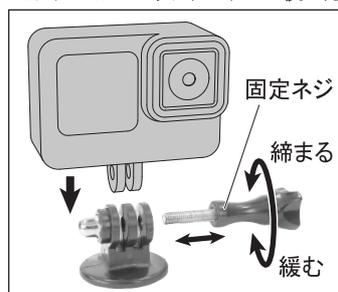
固定ネジを外し、アクションカメラの接続部を取り付けます。その後固定ネジでしっかりとアクションカメラを固定してください。
