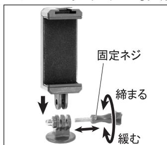
付属のスマートフォンホルダーはアクションカメラアダプターに取り付けて使用します。3.の要領でしっかりと固定してください。
