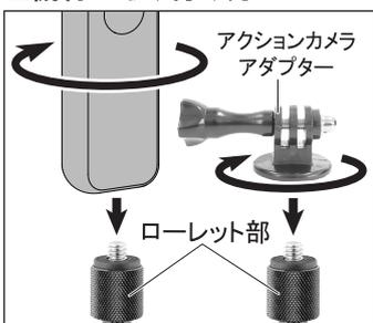
機材や付属のアクションカメラアダプターを取り付ける際は、ローレット部をおさえながら上図矢印方向に回して取り付けてください。
