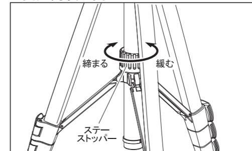
開脚角度を少し狭めて使用する場合は、中央のステーストッパーを必ずしっかりと締め、ステーを固定してください。
