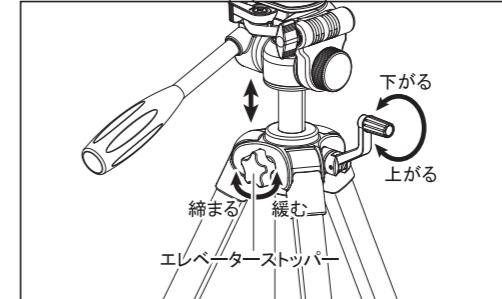
エレベーターストッパーを締め、クランクハンドルを回すとエレベーターの昇降ができます。必要な高さでエレベーターストッパーを締めて固定します(エレベーター操作は、必ず機材に手を添ながらおこなってください)。
