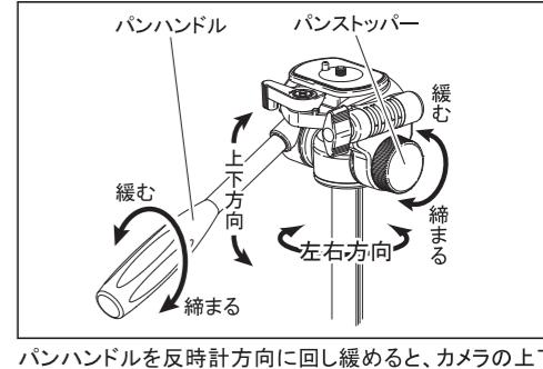
パンハンドルを反時計方向に回し緩めると、カメラの上下方向が変えられます。パンストッパーを緩めると、カメラを左右方向へ回転させることができます。
