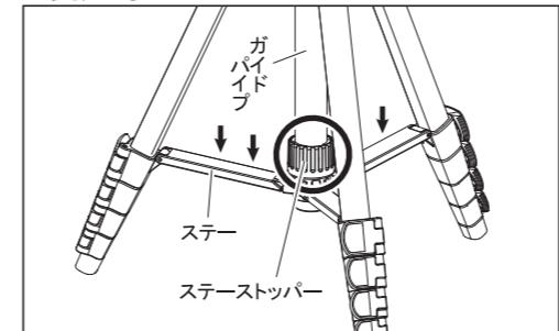
開脚時は、中央のステー付け根がガイドパイプの下端に届くまで、確実に開いてください。下端に届いていない場合は、ステーを上から手で押し下げて、届かせてください(ステーストッパーを締めると、より安定します)。
