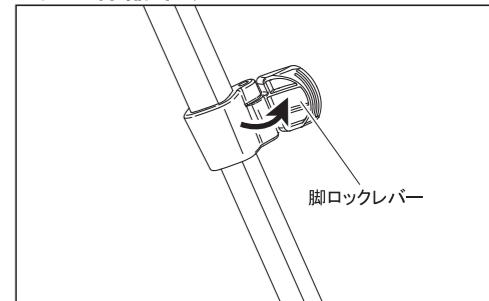
脚の伸縮は、脚ロックレバーを起こして脚を引出し、必要な長さで脚ロックレバーを倒して固定します。脚を全段引伸ばさないで使用する場合は、できるだけ太い脚を使って撮影してください。
