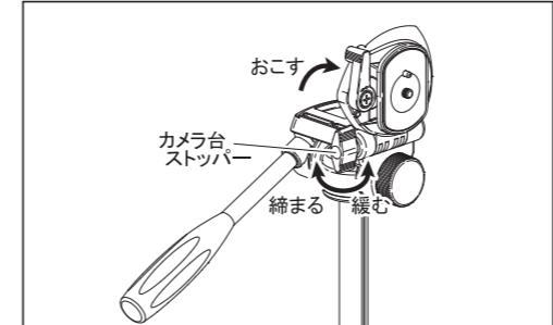
カメラ台ストッパーを緩めると、カメラの傾きが変えられます。フレームが決まった位置でパンハンドルとストッパーを確実に締め、シャッターをきります。
