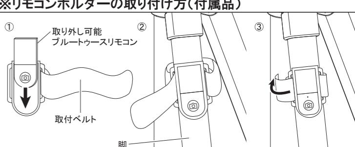
①リモコンを矢印方向にスライドさせセットします。
