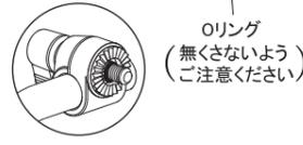
パンハンドルを上図の軸穴に差し込み、パンハンドル固定つまみを回して締め、しっかりと取り付けてください。右手でパンハンドルを操作したい場合は、パンハンドルを180度回して反対向きに取り付けてください。
