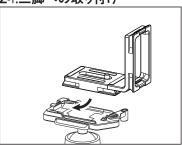
本製品は、三脚のクイックシュープレートの 替わりに直接三脚に取り付けます。取り付 けの際は、シュー固定レバーが緩んでいな いことを必ずご確認ください。
