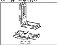
縦位置撮影をするには、プレート垂直部に ある縦位置用の取付ベースを使って三脚へ 取り付けます。カメラネジは再度しつかりと 締めて固定してください。
