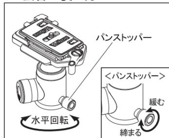
パンストッパーを回し緩めると、水平方向のみを独立して回転させることができます。構図を重視するような撮影で、フレーミングを調整する際に便利です。
