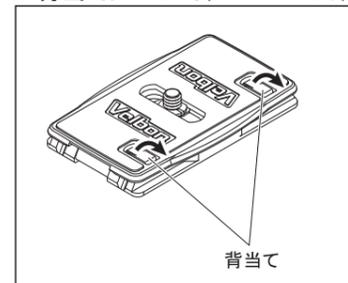
背当てをおこすと、カメラ縦位置時のレンズの重さによる前倒れを防ぐことができます。背当てはカメラネジ位置を移動させて、カメラの背面にうまく合わせてください。
