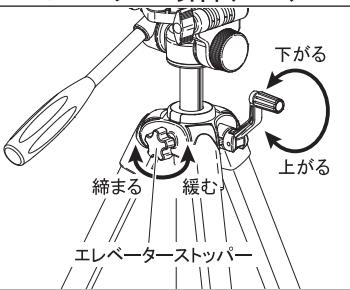
エレベーターストッパーを緩めクランクハンドルを回すとエレベーターの昇降ができます。必要な高さでエレベーターストッパーを締めて固定します。
