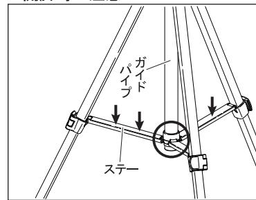
開脚時は、中央のステー付け根がガイドパイプの下端に届くまで、確実に開いて下さい。下端に届いていない場合は、ステーを上から手で押上げて届かせて下さい。
