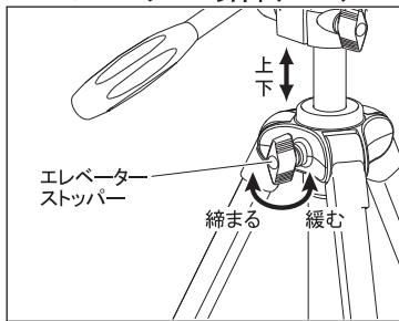
エレベーターストッパーを緩め、手動でエレベーター高さを調整して下さい。調整後、必要な位置でエレベーターストッパーを締めて固定します。
