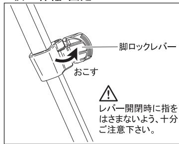
脚の伸縮は、脚ロックレバーを起こして脚を引き出し、必要な長さで脚ロックレバーを倒して固定します。脚を全段引伸ばさないで使用する場合は、できるだけ太い脚を使って撮影して下さい。
