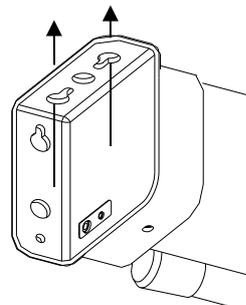
※付属の段付スペーサーを使用し、吊りボルト用取付穴での、付属ねじ(十字穴付きトラスタッピングねじ 4×30)固定も可能です。
