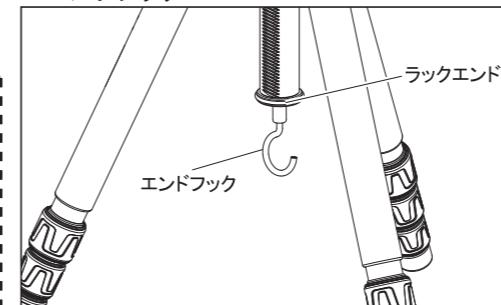
付属のエンドフックをラックエンドに取り付けることで、カメラバッグ等を吊り下げ、安定性を増すことが可能です。吊り下げたバッグが風にあおられるときの原因になりますので、ベルトは出来るだけ短くして吊り下げてください。
