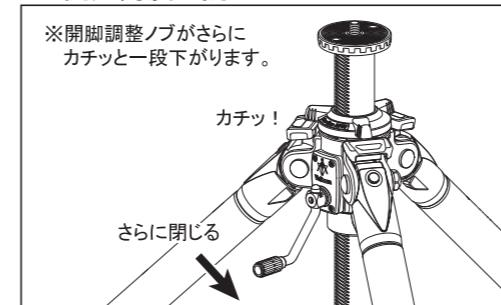
さらに脚を開じていくと、再び開脚調整ノブが自動的にカチッと一段下がります。なお、開脚角度は各々の脚で自由に設定することができます。
