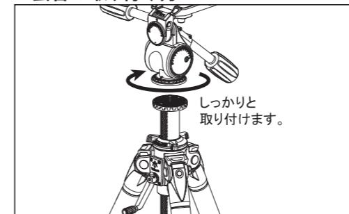
雲台(別売)を取り付けるには、雲台のハンドル棒や各ストッパー類、及び三脚のエレベーターストップバーをしっかりと締め、雲台底面の取付ネジ穴と三脚側の雲台取付ネジを確実に合わせて、雲台全体を上図矢印方向にゆっくりと回してしっかりと固定します。
