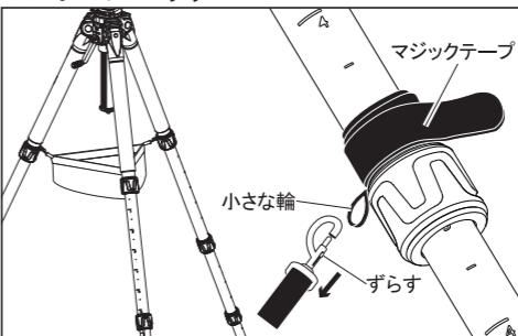
風の強い場所では、重し入れとしてストーンバッグをお使いください。バンドの小さな輪ができる方を内側にして、3本の脚それぞれにマジックテープできつと巻きつけます(上図)。その輪にストーンバッグのフックを引っかけて使用します。
