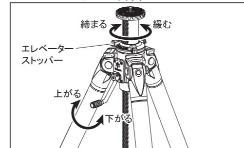
エレベーターストップバーを回して緩め、クランクハンドルを回すと、エレベーターの昇降ができます。必要な高さでエレベーターストップバーを締めて固定してください。
