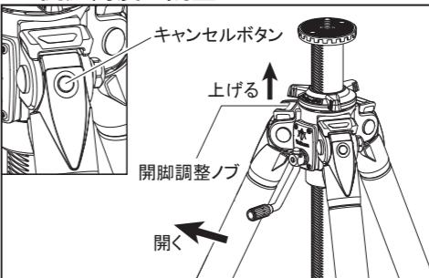
脚を開じた状態で、開脚調整ノブをカチッと止まる位置まで上に引き上げ、脚を一杯に開くとフル開脚となります(フル開脚ではエレベーターを上げてください)。本製品のフル開脚は、不整地での調整用となります)。なお、誤ってノブを引き上げてしまった場合は、キャンセルボタンにより元の位置に戻すことができます。
